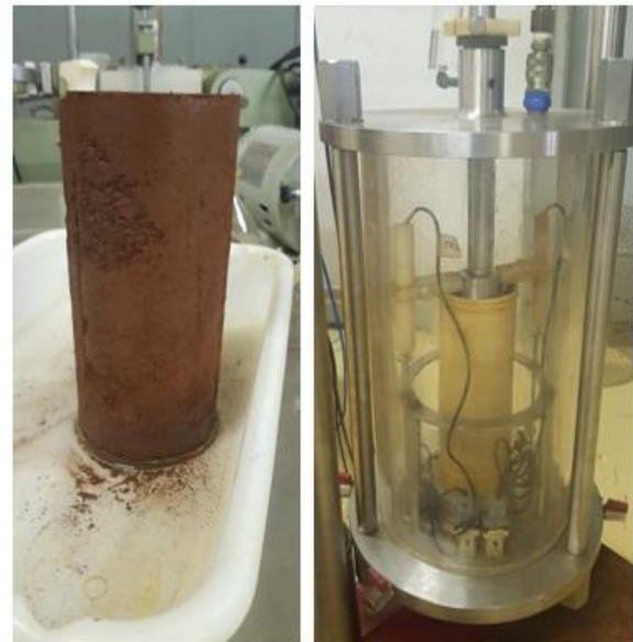
Figura 2 – Corpo de prova em processo de adição de umidade e ensaio triaxial de cargas repetidas
