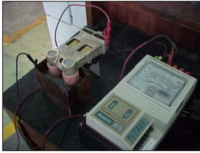
Figura 11 - Verificação das condições do material isolante
