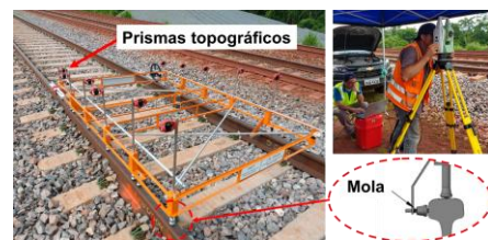
Fig. 7 Dispositivo Medidor de Perfil Topográfico (DMPT)
