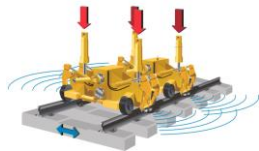
Fig. 3 Princípio da estabilização dinâmica da via [5]
