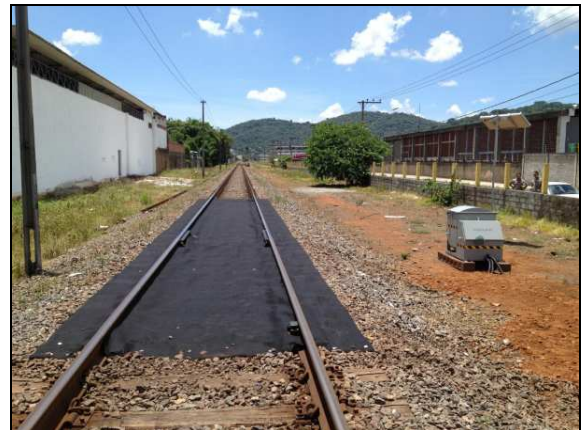
Figura 4: Lubrificador eletrônico Protector IV LB Foster.
