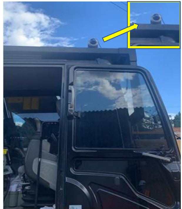
Fig. 4 Câmera montada no alto do equipamento
