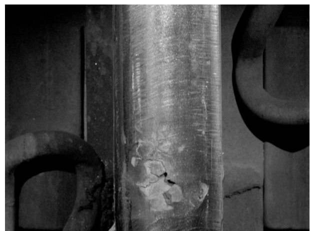
Fig. 2 Imagem de Trilho com defeito, coletada pelo RIV
