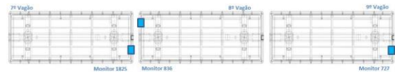
Figura 5. Desenho esquemático com a localização aproximada dos equipamentos de medição (em azul).
