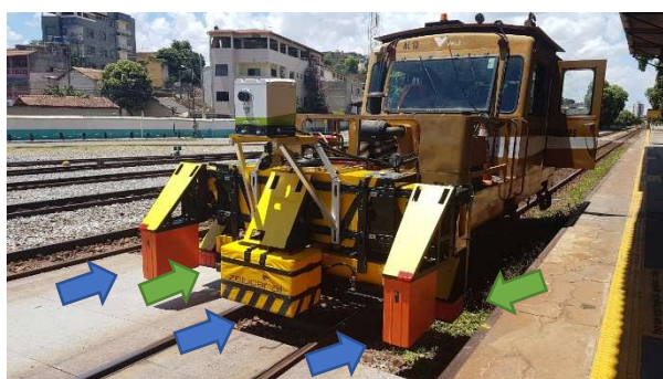
Fig. 3 Sistema de medição da Zetica Rail instalado no auto de linha da EFVM. As setas azuis indicam antenas de 2 GHz e as setas verdes indicam as antenas de 400 MHz.
