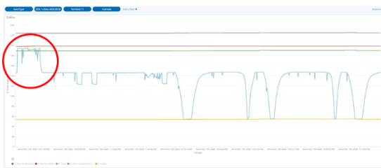
Fig. 10 Exemplo de fenômeno detectado pela IA com aspecto de trilho quebrado. [3]
