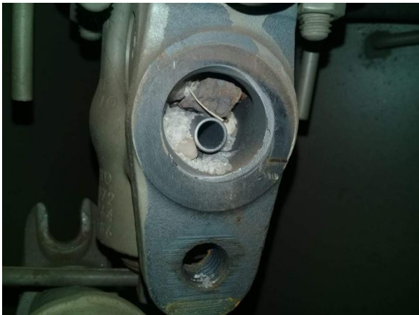
Figura 9. Entupimento nos bicos injetores causado por areia fora do padrão
