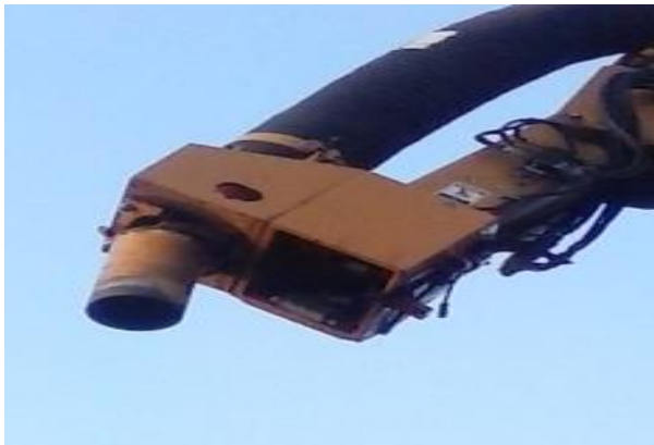
Fig. 2: Bico quebrado após colisão com o vagão
