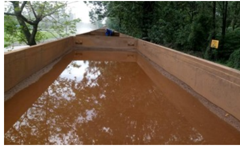
Figura 9 – Vagão com dreno convencional.
