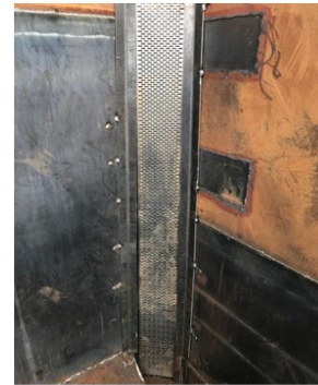
Figura 5 – Dreno vertical na lateral do vagão.
