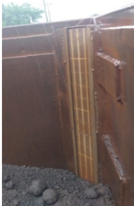
Figura 8 – Vagão com dreno vertical, sem acúmulo de água.
