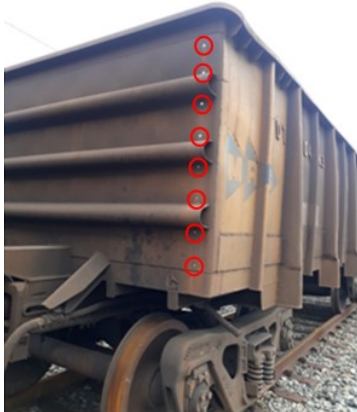
Figura 2 – Primeiros drenos de água no vagão de minério.
