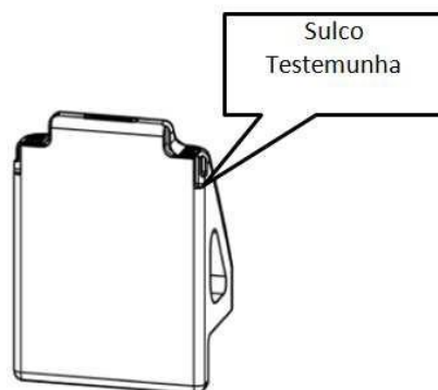
Figura 2: Ilustração do Sulco Testemunha
